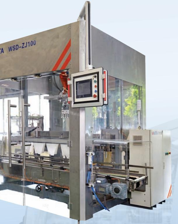
机械手装箱机采用变频调速，配上合适的吸盘或抓手，由抓头充、排气来实现抓、放产品，通过机械运转、气动和电控制把产品准确可靠的从输送带上装入箱中。多规格产品装箱转产调整工作量小，广泛应用于纯净水、饮料、酒类、日化以及食品行业包装生产线，装箱速度达40箱/分钟。
