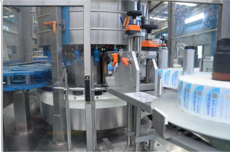
回转式热熔胶贴标机
