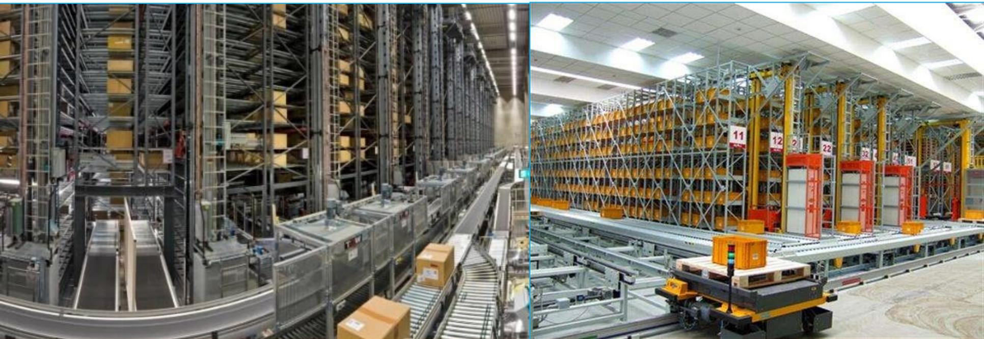
智能立体仓库由高层货架及托盘、升降机、机器人、穿梭车、链式输送机、RGV输送车、仓储管理系统等组成。
